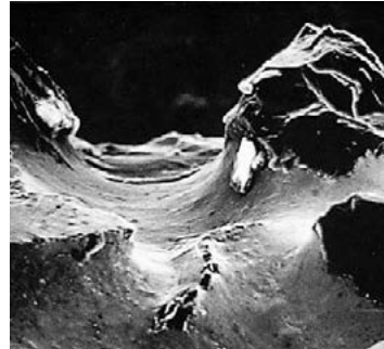
Diamantierter Schleifkörper mit Naturdiamanten: Die unregelmäßige Oberfläche der Kristalle bewirkt eine enorme Schleifkraft (REM-Aufnahme)
